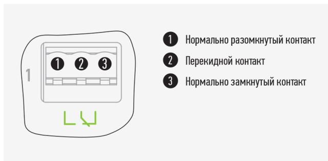
Рис. 15. Распиновка разъема реле (поз. 10, 12 рис. 3)
