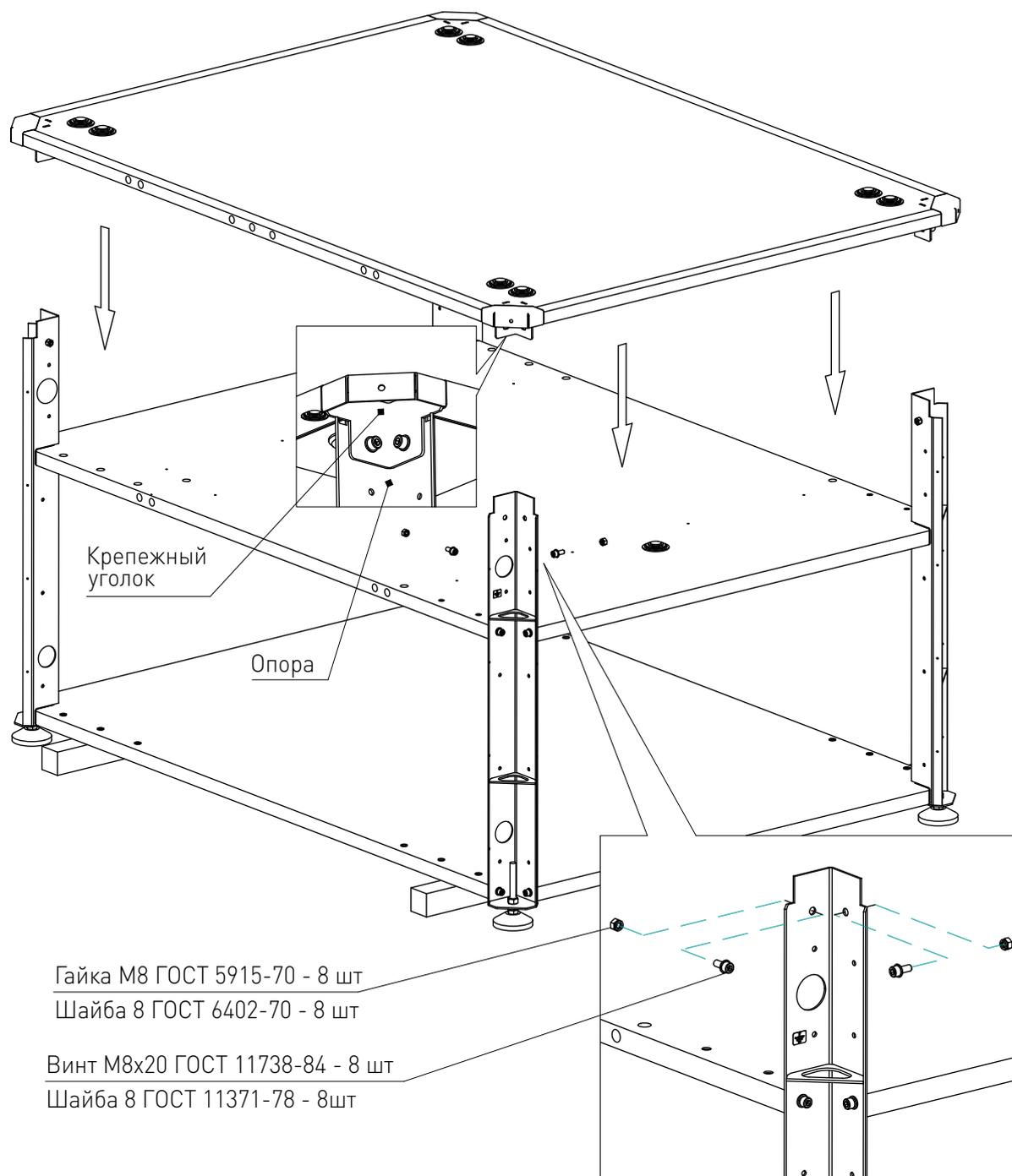
Рисунок 6 — Монтаж столешницы.
