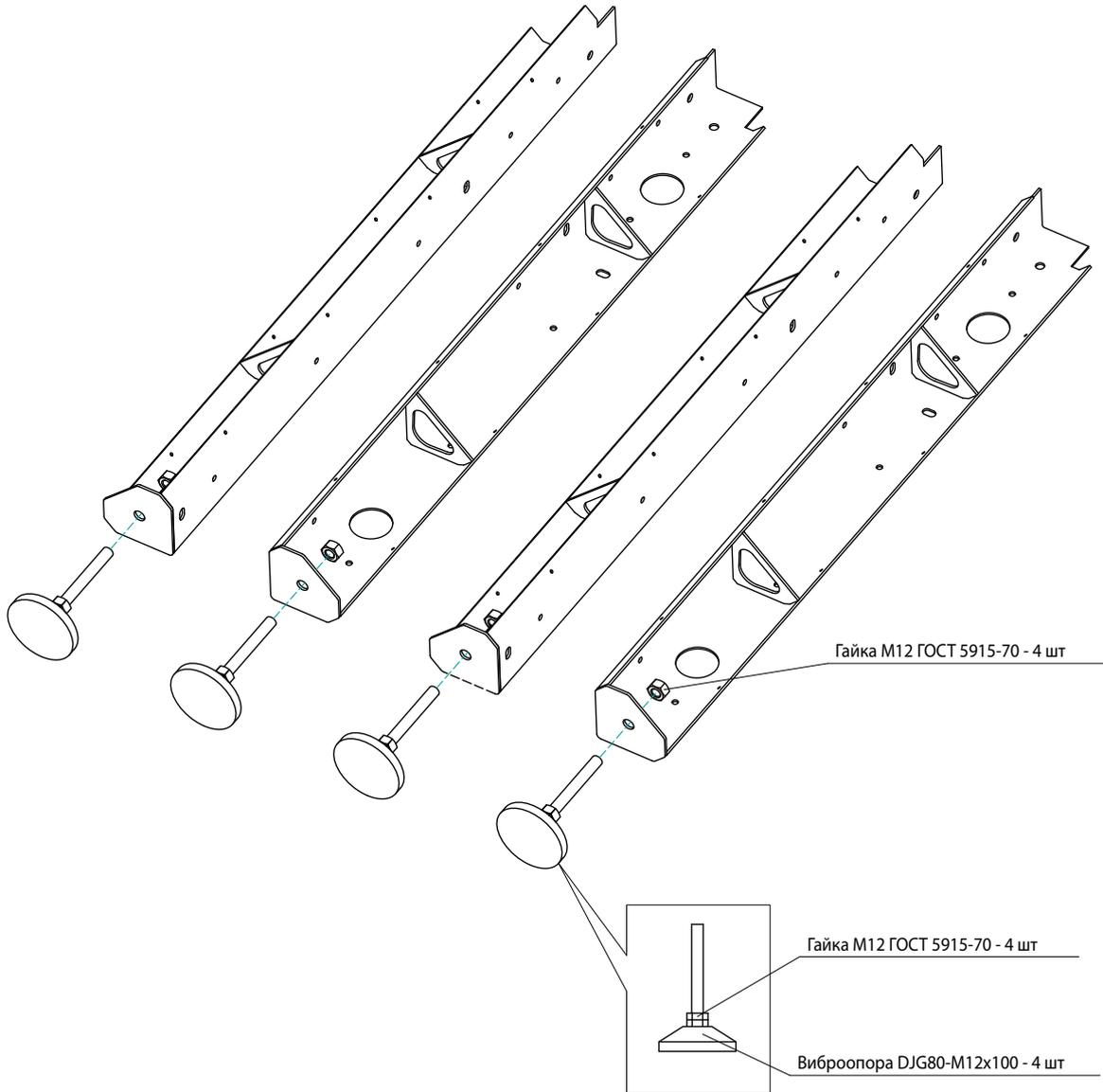
Рисунок 3 — Сборка опор.
