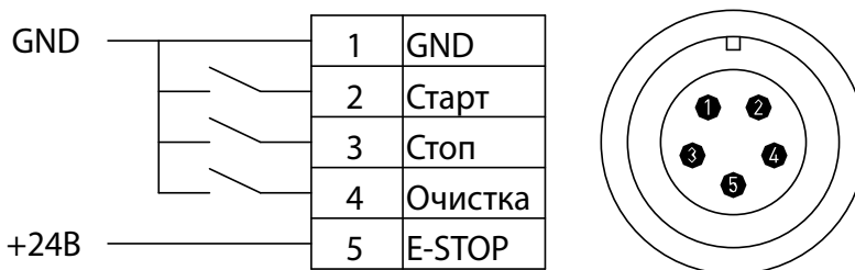
Рисунок 9 — Распиновка разъема подключения к системе с ЧПУ.
