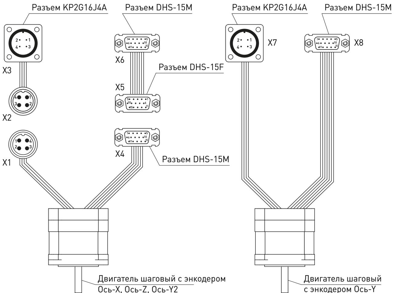
Рисунок 9 — Схема электрических соединений двигателей в станке.
