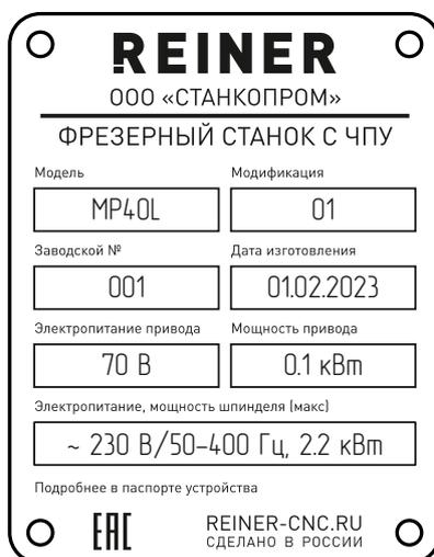
Рисунок 13 — Шильдик.
