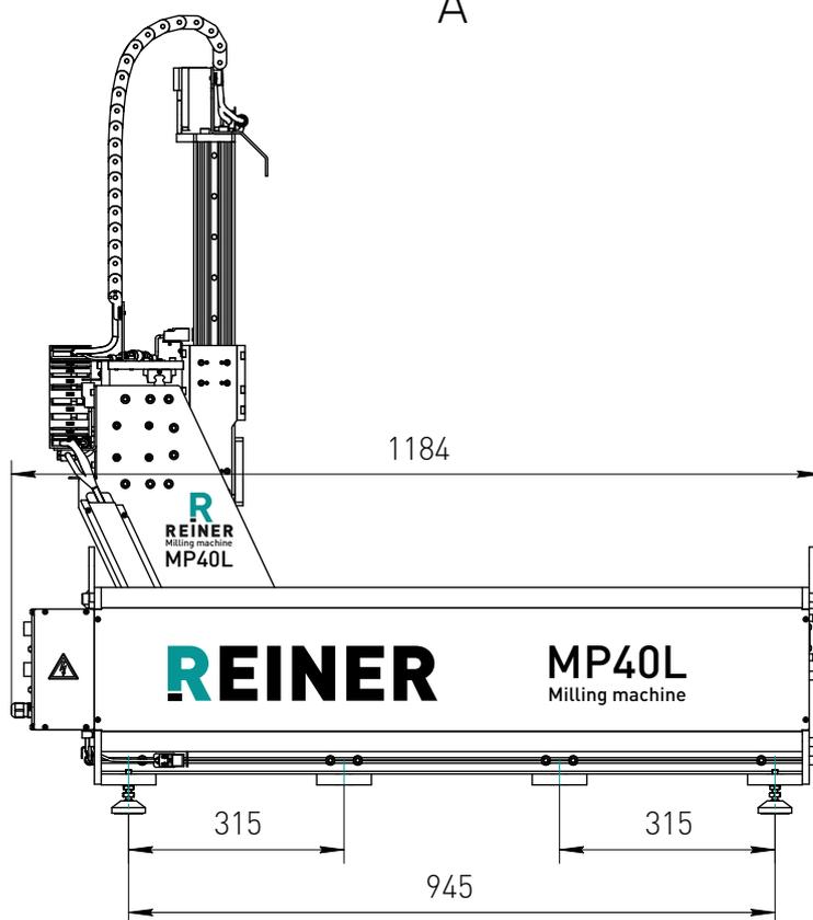
Рисунок 3 — Габаритные размеры фрезерного станка с ЧПУ REINER MP40L.
