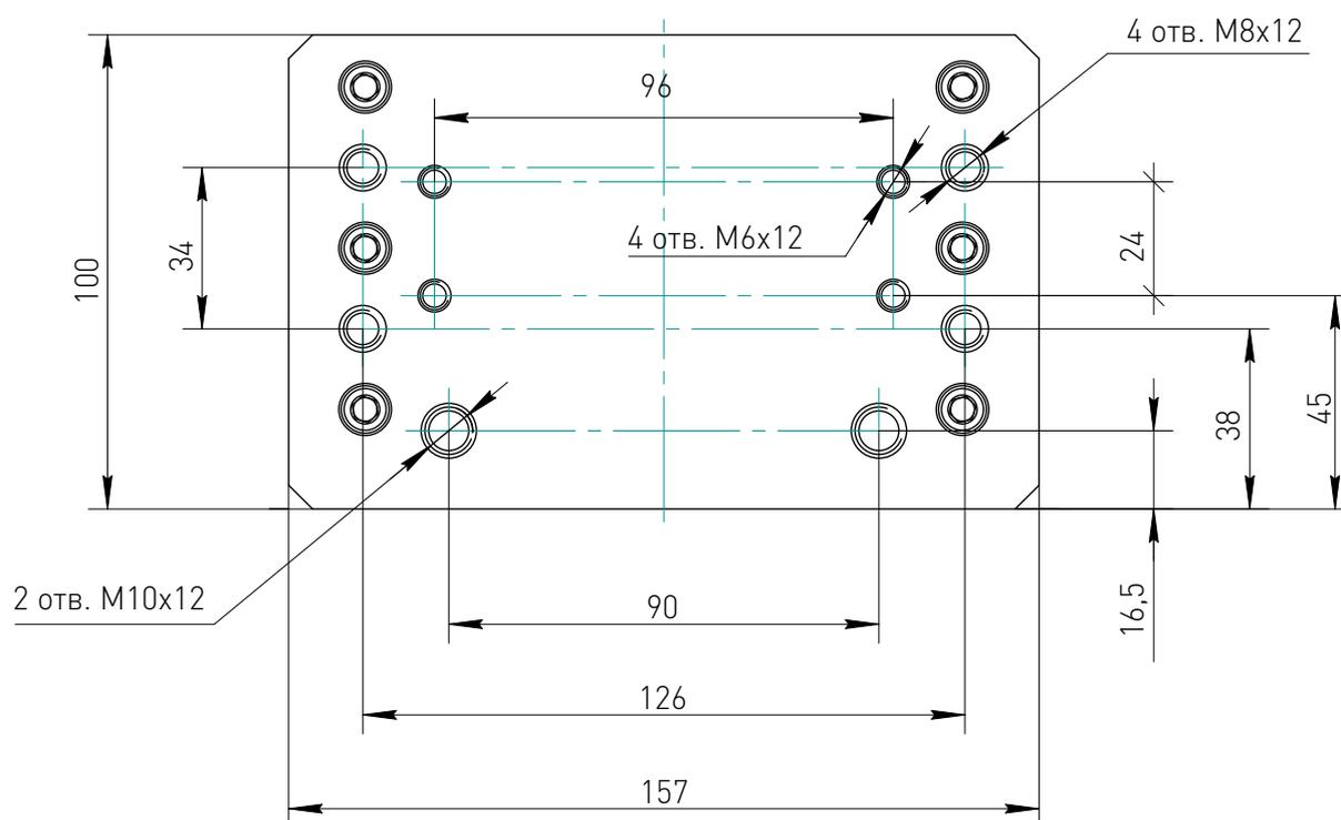
Рисунок 2— Плита шпинделя.
