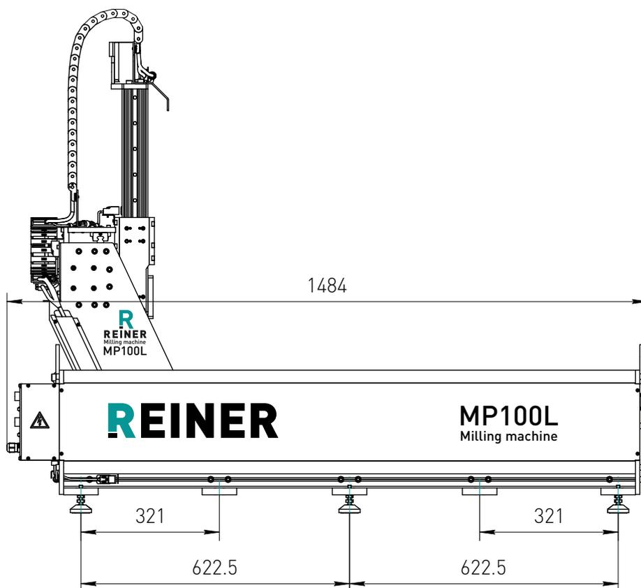
Рисунок 5 — Габаритные размеры фрезерного станка с ЧПУ REINER MP100L.
