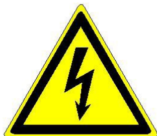
Рис. 5. Опасность поражения электрическим током
