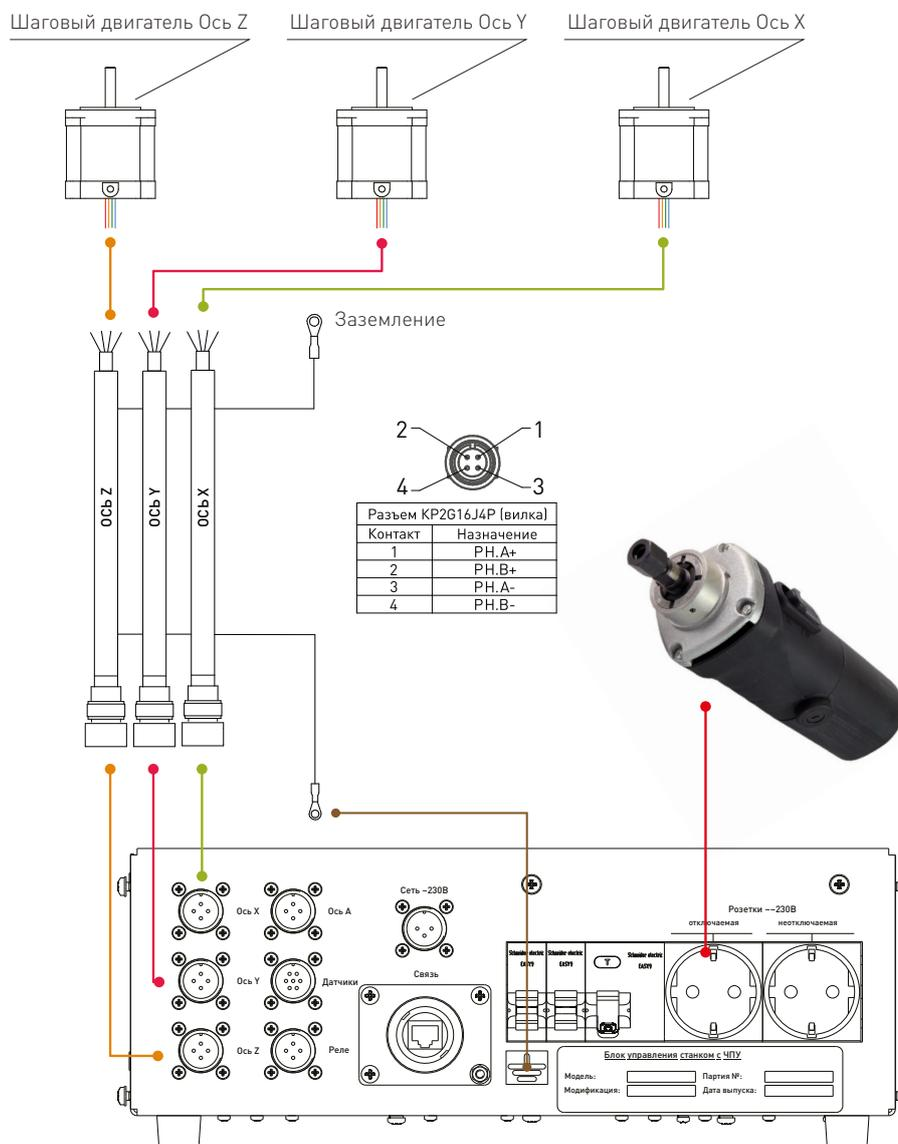
Рис. 7. Схема подключения REINER MH08-S1 и REINER MH08-S2 к блоку управления станком с ЧПУ CNC57L
